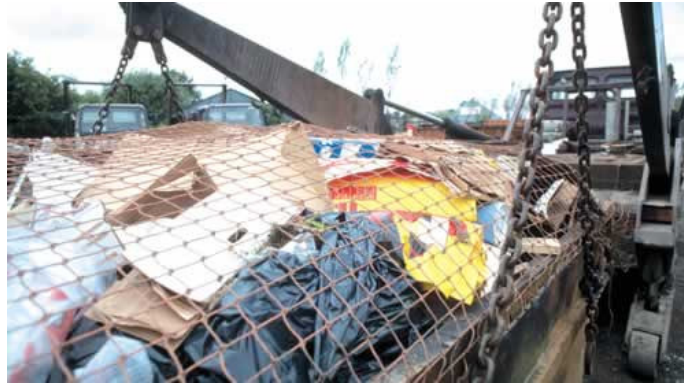
تصویر شماره (۶-۷): شبکه توری برای حمل زباله‌ها
