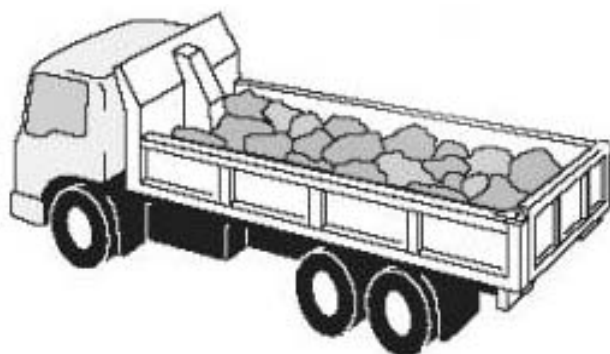
شکل شماره (۶-۶۱) : حمل بارهای فله‌ای توسط تیپر
